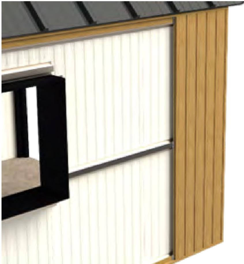
8 - No fim de montagem ou alguma obstrução como janelas, caso termine com uma peça recortada, utiliza-se um perfil de reforço, para segurar a peça recortada na posição.
