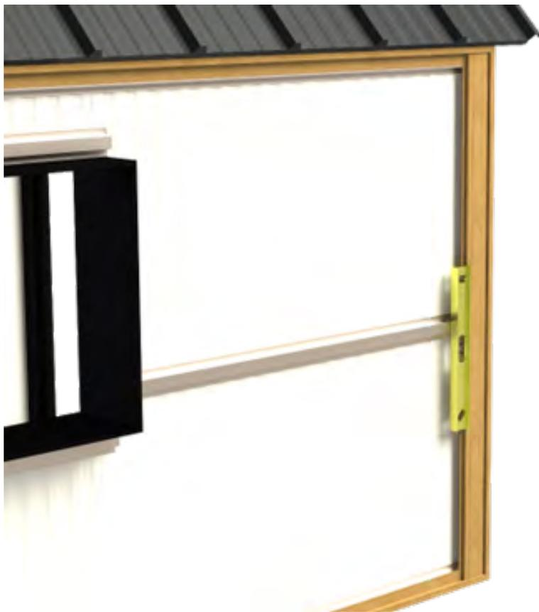
5 - Depois de nivelada, faz-se a fixação com cliques e parafusos K-Lath.
