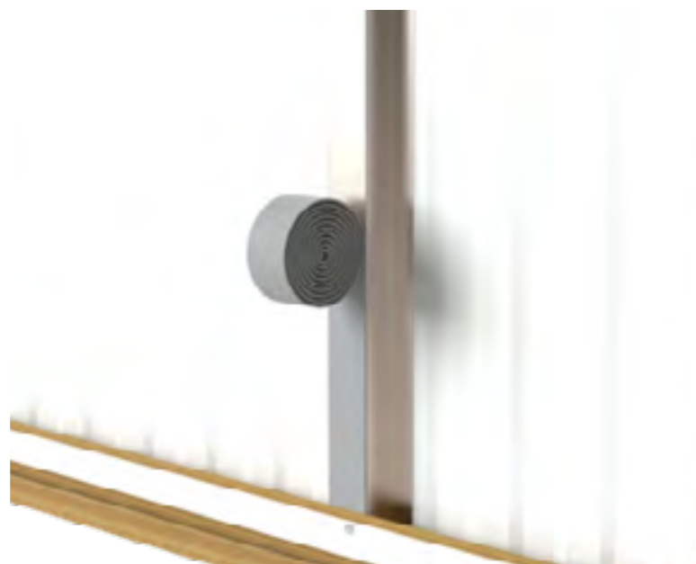
APLICAÇÃO DA FITA ACÚSTICA NA ESTRUTURA
