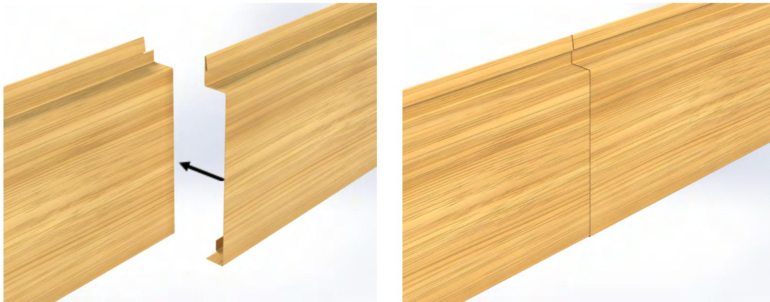
6 - A montagem dos perfis segue então de baixo para cima realizando emendas entre as linhas de Infinity Wall. As emendas podem ser realizadas alinhadas ou desencontradas, dependendo da paginação do projeto e estrutura de apoio.
