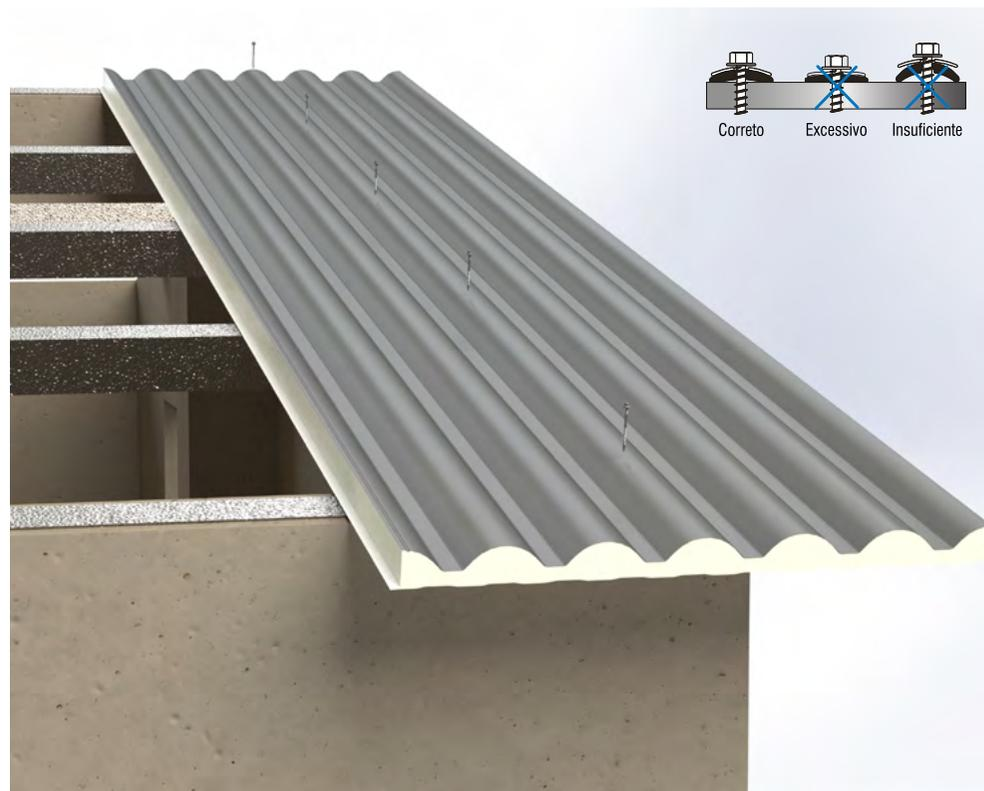
3. Fixar os parafusos de costura na sobreposição lateral e os parafusos de fixação nas terças. Consumo: 3 parafusos de costura por metro de telha e 3 parafusos de fixação nas telhas em cada terça.
