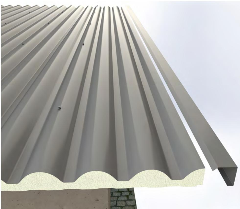
2. Utilizar o rebitador alicate para fixação do rebite hermético 4,0x15 mm a cada 200 mm. Rebites bem próximos da borda do rufo.
