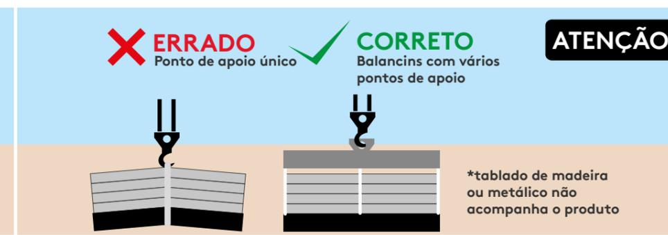
Para manuseio com guincho, dos produtos Kingspan Isoeste devem ser apoiados sobre um tablado de madeira ou metálico tomando-se o cuidado para a cinta do guincho não encostar na lateral do produto.
