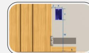
01. Obter as medidas da posição da tomada para identificar onde o perfil Infinity Wall precisa ser recortado;
