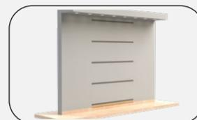
9. Aplicar 5 tiras de fita PVC ao longo da parede espaçadas igualmente (aproximadamente 0,60m);
