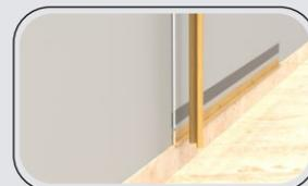
11. Posicionar o perfil de acabamento lateral de início de montagem, que é travado no acabamento existente;
