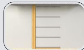
15. Utilizar 3 cliques por perfil Infinity Wall (distanciamento máximo entre cliques de 1,50m);
