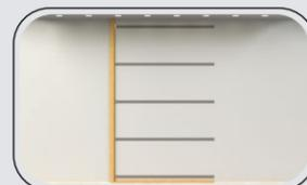
13. Utilizar 3 pontos de fixação do perfil Infinity Wall com o clipe, parafuso(s) e bucha(s), seguindo distanciamento máximo entre cliques de 1,50m;
