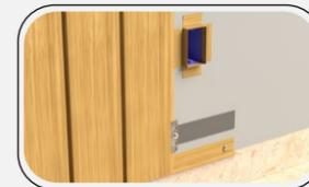
3. Recortar, de acordo com as medidas obtidas, a próxima peça de Infinity wall e posicionar na sequência de montagem;
