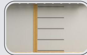
15. Utilizar 3 cliques por perfil Infinity Wall (distanciamento máximo entre cliques de 1,50m);
