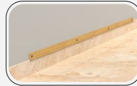
7. Realizar a fixação do perfil em 4 pontos na parede;
