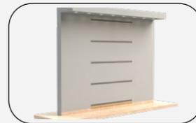
9. Aplicar 5 tiras de fita PVC ao longo da parede espaçadas igualmente (aproximadamente 0,60m);
