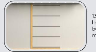
13. Utilizar 3 pontos de fixação do perfil Infinity Wall com o clipe, parafuso(s) e bucha(s), seguindo distanciamento máximo entre cliques de 1,50m;
