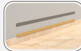
8. Aplicar a primeira linha da fita de espuma de PVC, cerca de 150mm do rodapé, em todo o comprimento onde serão instalados os perfis Infinity Wall;
