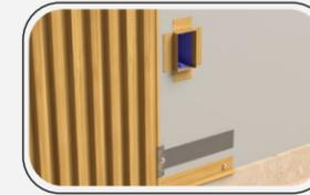
3. Recortar, de acordo com as medidas obtidas, a próxima peça de Infinity wall e posicionar na sequência de montagem;
