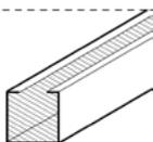
Principal elemento do forro metálico. São perfis em alumínio pré-pintado com #0,45mm de espessura, 30 mm de largura, 37 mm de altura e 2,8 metros de comprimento, encaixados as travessas estruturais.
