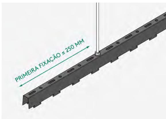
**Passo 2:** O primeiro ponto de fixação na Travessa Estrutural deve ser feito a uma distância máxima de 250mm de sua extremidade.
