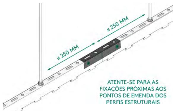
**Passo 6:** Para estes casos, os pontos de fixação da estrutura ao substrato devem acontecer a uma distancia máxima de 250mm da extremidade da Travessa.
