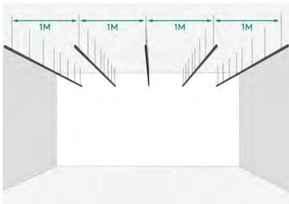
**Passo 1:** Os Perfis Estruturais devem ser fixados no sentido de maior dimensão do ambiente, com 01 metro de afastamento entre si. Estes Perfis serão fixados ao substrato por meio de barras roscadas de 4 à 6mm de diâmetro.
