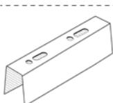
Peça de emenda em aço pré-pintado com #0,60mm de espessura, 140mm de comprimento, destinada a unir as travessas estruturais através de fixadores mecânicos, quando necessário.
