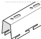
Perfil em aço pré-pintado com #0,60mm de espessura, 2,8 metros de comprimento, na cor preta, fixado a laje através de hastes roscadas. Possui abas para encaixe por pressão dos Perfis Itália a um passo de 70mm.
