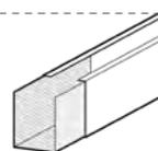
Peça em alumínio pré-pintado com #0,40mm de espessura, 30 mm de largura, 37 mm de altura e 110 mm de comprimento, encaixada no interior dos Perfis Itália a fim de uni-los, quando necessário.
