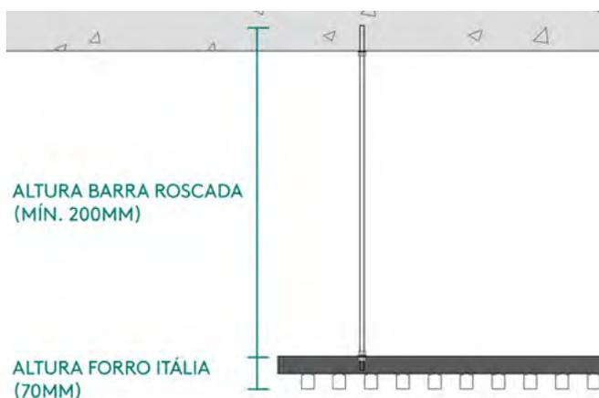
O comprimento mínimo das barras rosçadas deve ser 200mm. Considere 70mm para altura do forro Itália, perfis + estruturas.
