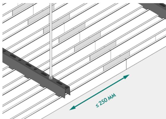
**Passo 3:** Ao realizar emendas nos Perfis Itália, atente-se para que as Travessas Estruturais estejam alocados a uma distância máxima de 250mm da extremidade dos Perfis Itália.
