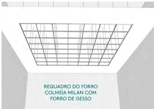
**Passo 3:** Não é recomendado o recorte dos perfis e grelhas em obra. A modulação do forro deve ser feita de acordo com o espaço disponível para sua aplicação. Para instalação do forro em ambientes com dimensões não compatíveis, a recomendação é fazer o acabamento perimetral do ambiente com forro de gesso.
