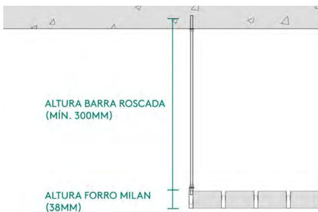
O comprimento mínimo das barras roscadas deve ser 300mm.
