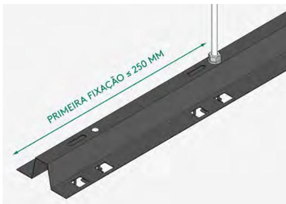
**Passo 2:** O primeiro ponto de fixação no Perfil Estrutural deve ser feito a uma distância máxima de 250 mm de sua extremidade.
