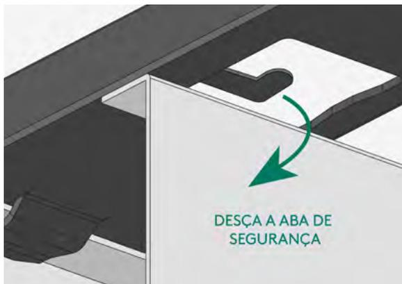
**Passo 2:** Ao encaixar os Perfis Baffle à estrutura, desça a aba de segurança para travamento dos Baffles na posição, como mostra a figura.
