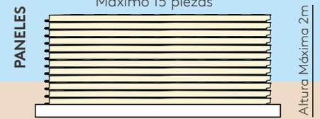
La forma correcta de apilar las TEJAS o PANELES es colocar EPS o calzas de madera debajo de ellos y atarlos. Coloque calzas con una separación máxima de 1 m entre ellas.
