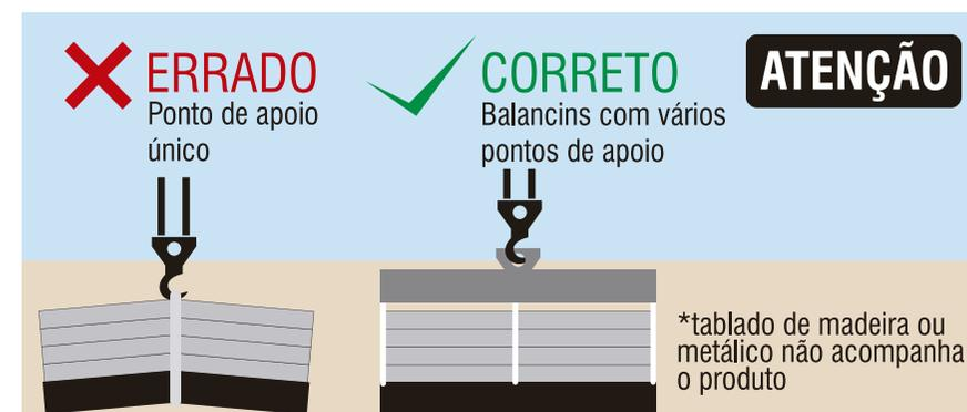
**Para manuseio com guincho, as TELHAS ou PAINÉIS devem ser apoiados sobre um tablado de madeira ou metálico tomando-se o cuidado para a cinta do guincho não encostar na lateral do produto.**
