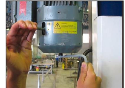
4. Encaixe a manivela na parte de baixo do motor e movimente-a no sentido desejado (abertura ou fechamento).
