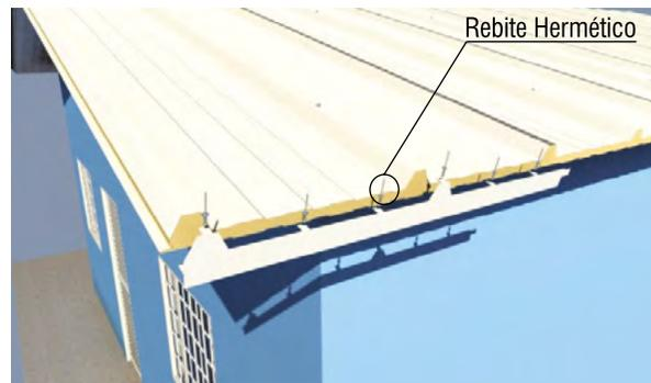
11. Iniciar a fixação dos acabamentos frontais. O sentido de montagem destes acabamento deve ser sempre da esquerda para a direita. Utilizar broca de 4,5mm para furação.
