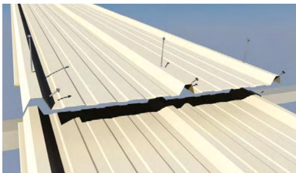
6. Utilizar os parafusos para fixar o transpasse na telha abaixo, em seguida utilizar os parafusos de fixação. Consumo: 2 parafusos por transpasse.
