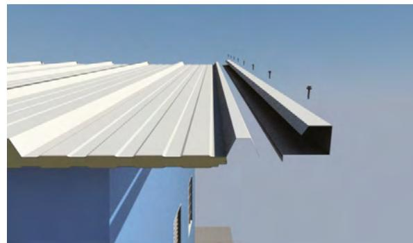
15. Fixar o acabamento lateral tipo (B) na primeira telha montada através do parafuso de fixação, utilizando a parafusadeira.
