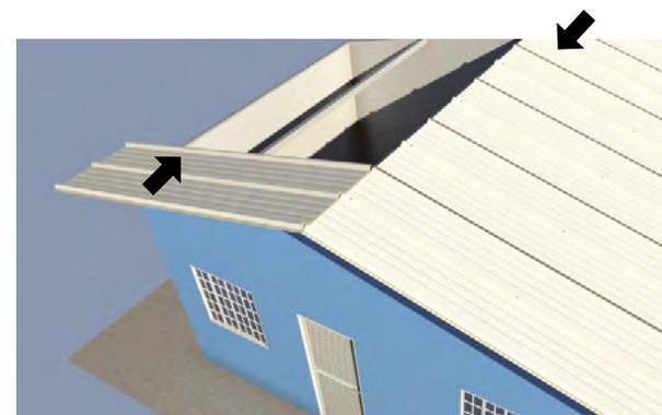
9. Após a montagem das 2 águas, posicionar a cumeeira trapezoidal na cobertura.
