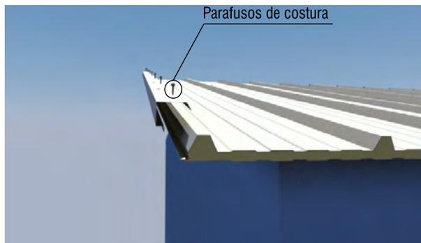
14. Fixar o acabamento lateral tipo (A) na última telha montada através do parafuso de costura, utilizando a parafusadeira.
