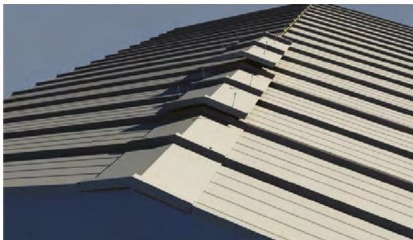
10. A fixação desta cumeeira é feita com os mesmos parafusos de fixação das telhas nas terças. Nos casos em que a terça está na cumeeira, a fixação desta peça passa a ser através de parafusos.
