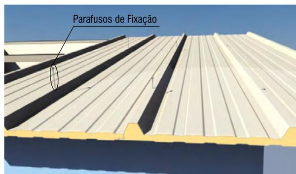
4. No caso de transpasse de telhas, fixar primeiramente a telha mais próxima ao beiral, em seguida posicionar a telha superior com o transpasse. A largura mínima da terça neste caso é 100 mm.
