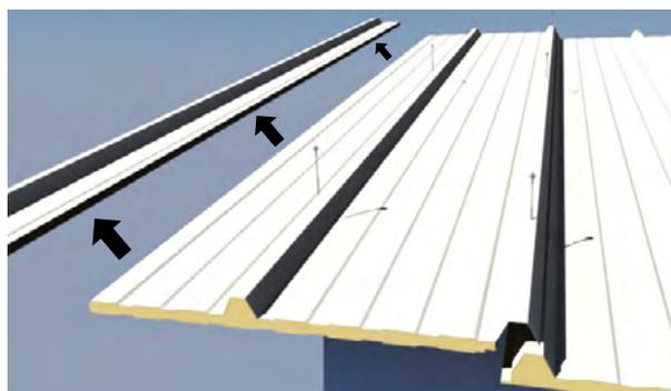
8. Após a montagem da 1ª água, iniciar a fixação das telhas da 2ª água da cobertura.
