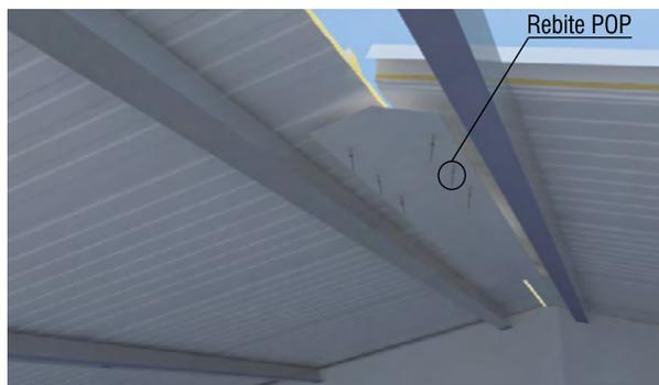
17. Fixar o acabamento interno através do rebite POP de alumínio 4,0x15mm, utilizando o rebitador.
