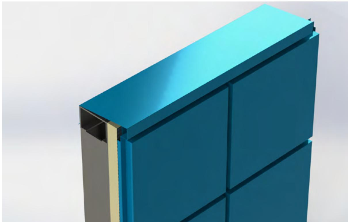
Os detalhes de acabamento de canto da obra devem ser previstos na fase de projeto, podendo-se utilizar uma peça pronta produzida em fábrica.
