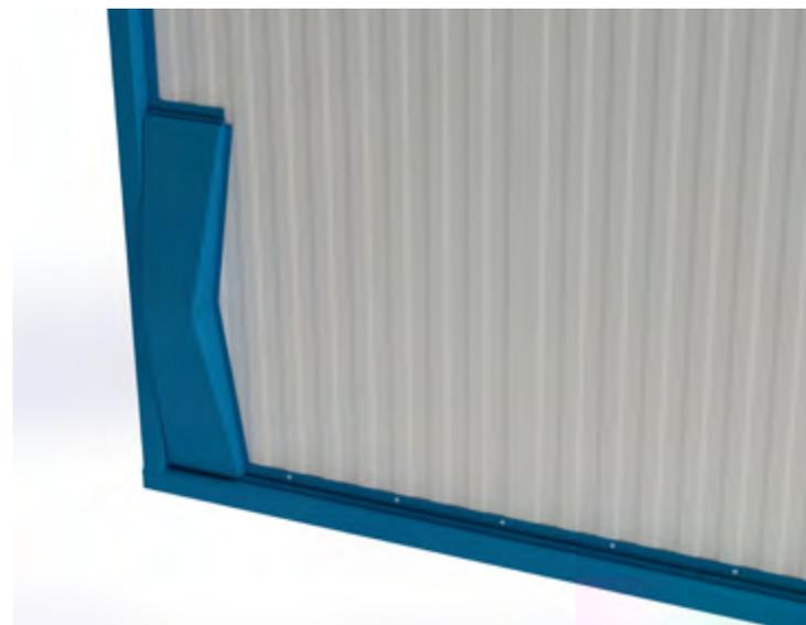
Atenção na montagem para permitir sempre um espaçamento de 2mm em todo o perímetro da peça, para que possa dilatar livremente, na parte inferior os 2 mm devem ser obedecidos em relação ao J inferior:
