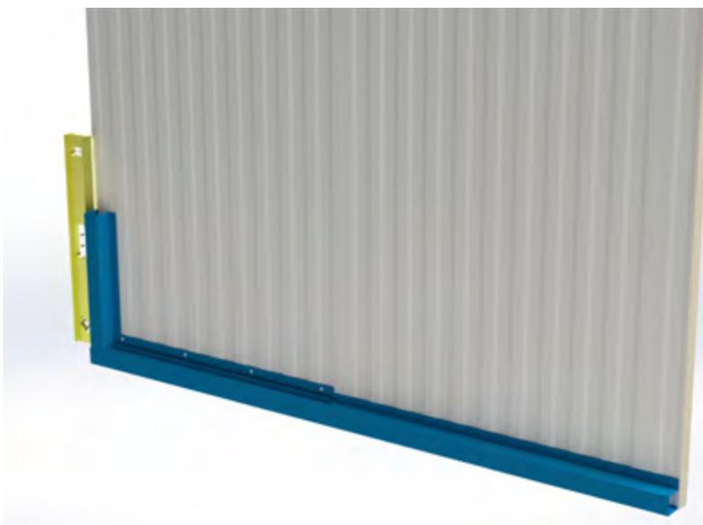
O acabamento "J" deve ser instalado com ao menos 5mm de distância do acabamento inferior com uso de rebites, 4 por peça, para permitir os drenos de água, sempre aferir o nível do acabamento pois ele será a referência base das peças montadas em sequência:
