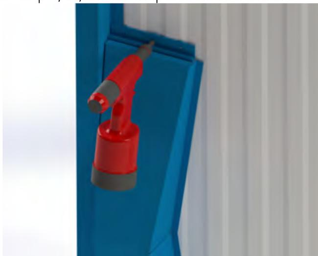
Após a conclusão do posicionamento, realizar o furo onde irão os rebites:
