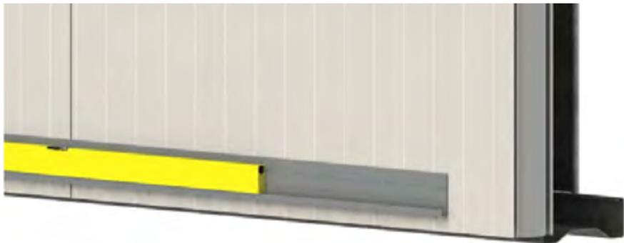
Após o nivelamento inferior, caso o projeto de referência tenha um perfil de acabamento lateral, utilizá-lo como referência para verificação do prumo da montagem:
