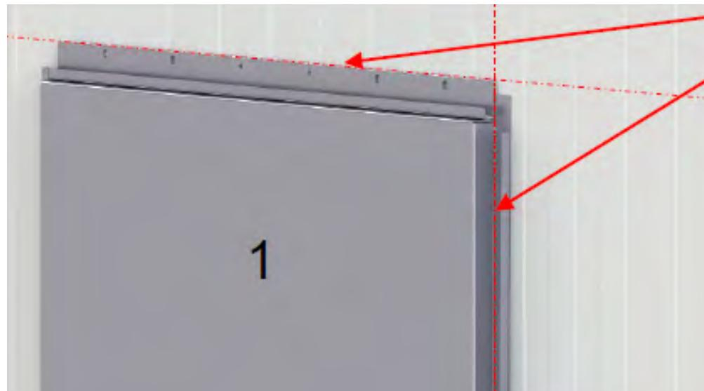
Furar através dos dois pontos centrais fixos com uma furadeira e broca de 4.9 mm de diâmetro.
