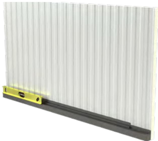
O acabamento "J" deve ser instalado com ao menos 5mm de distância do acabamento inferior com uso de rebites, 4 por peça, para permitir o dreno de água, sempre aferir o nível do acabamento pois ele será a referência base das peças montadas em sequência:
