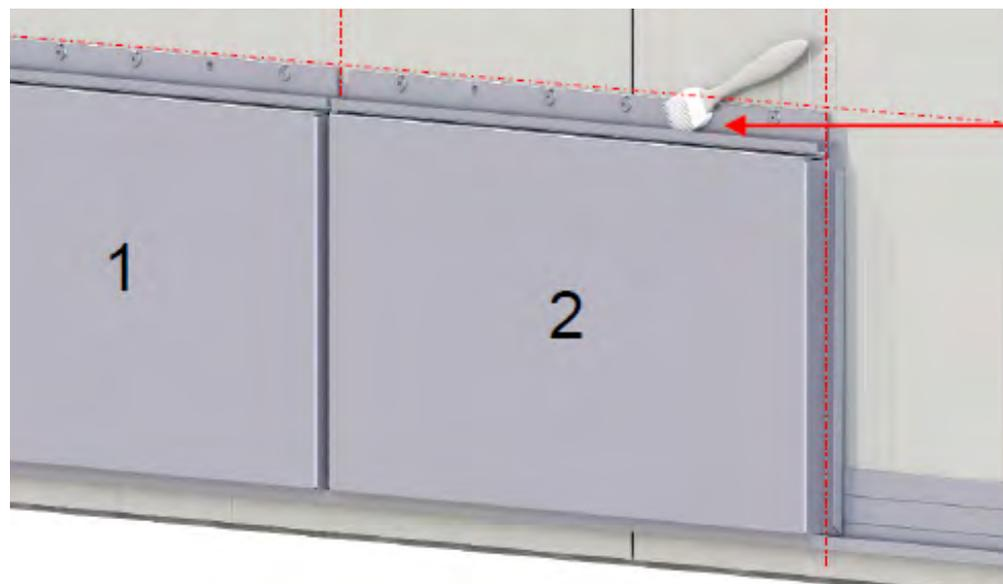
Manter o procedimento de montagem em toda área da parede a ser revestida. O sentido de montagem será da esquerda para a direita, e de baixo para cima.
