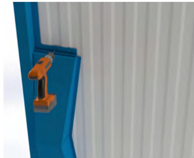
Montar primeiramente uma coluna de peças, respeitando o espaço livre de 2 mm entre elas:
