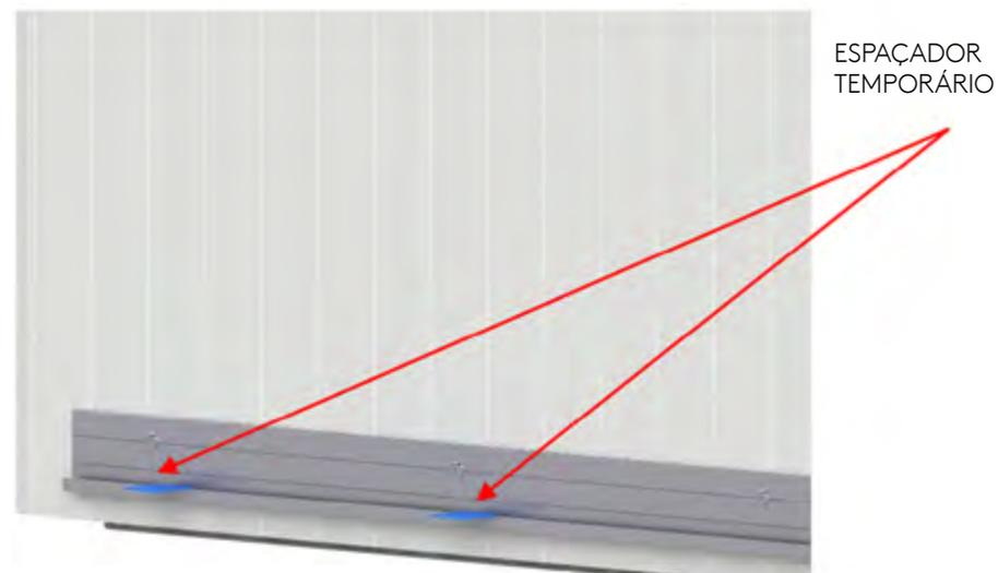
Posicionar então a primeira peça deixando um espaço de 2 mm entre a peça e o perfil lateral, conferindo o nivelamento da peça antes de prosseguir com a montagem.
